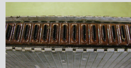
錆びたラジエータ
