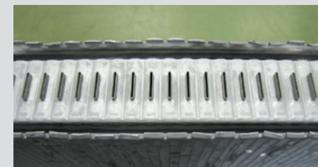
正常なラジエータ
