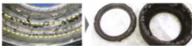
タイヤの内側がこすれ、損傷を受けたタイヤ(内側からはわかりにくい)
