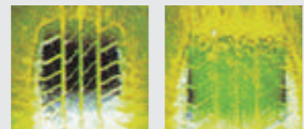
新品タイヤはしっかり排水している 残溝1.6mmのタイヤは排水性が低下し接地面が水に浮いている
